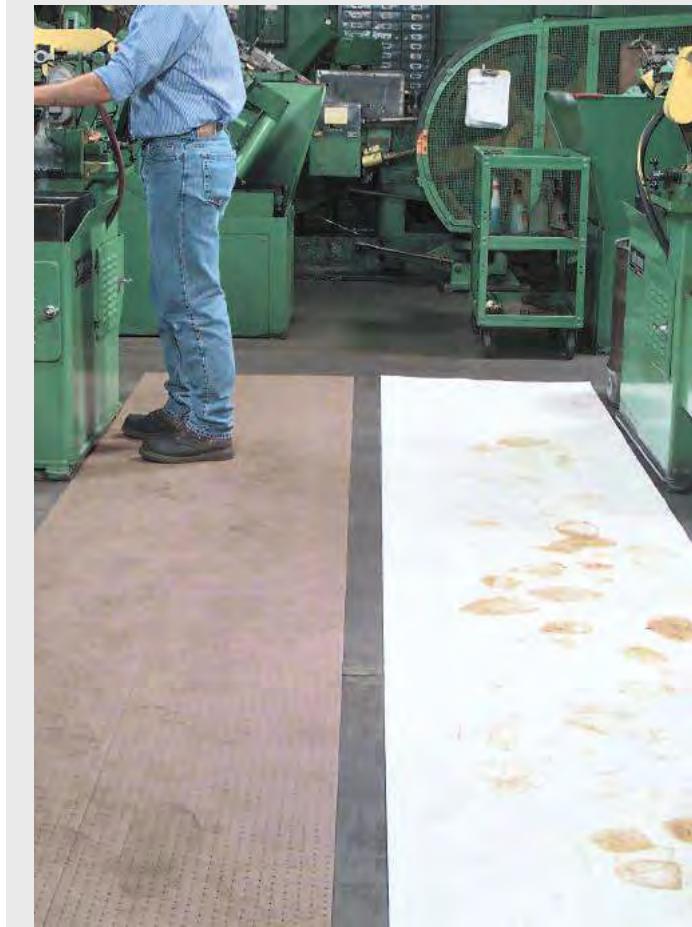
흰색 유흡착제와 달리 브라운 유흡착제는 어떤 현장환경에서나 적용이 가능하며 기름을 흡수한 뒤 흡착제가 더러워져도 티가 잘 나지 않기 때문에 현장에서 더욱 오랫동안 사용할 수 있습니다.
